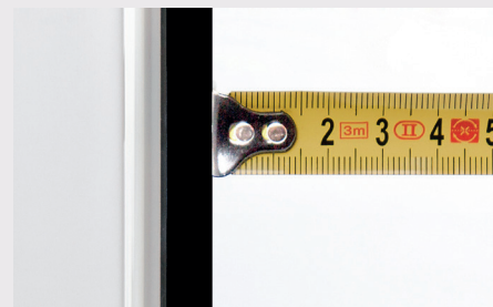
Gummidichtung breiter als 5,1 mm
